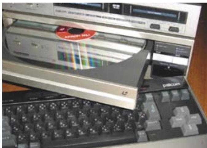
e um LaserDisc Player\*, que são interconectados por uma conexão serial proprietária. É através de tal conexão que o MSX envia os comandos para o player, tais como avanço, retrocesso, parada do disco etc.
